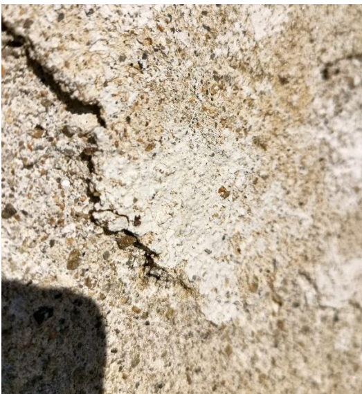
Fot. 28. Pozostałości pobiałej na warstwie nr 4 (zaprawa wapienno-piaskowa, gruboziarnista).
